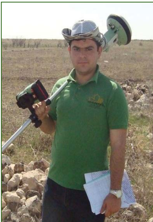
Рис. 4 Измерения в режиме RTK приемником ГНСС Leica Viva GS15
